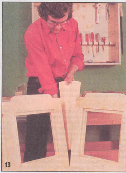
13 После крепления рам сидений основу скамьи можно считать готовой. Теперь необходимо соединить между собой обе спинки. Для этого между ними вклеивают и с двух сторон крепят шурупами деревянный клин.
