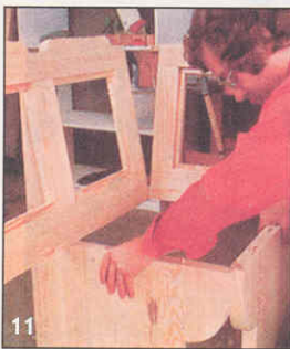
11 Угловые ножки склеивают под прямым углом перед установкой на них рам сидений.
