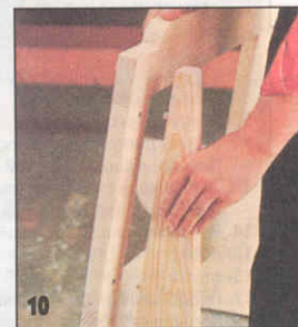
Раму спинки соединяют с ножками скамьи на шкантах с клеем.
