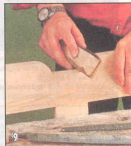
Кромки фигурных вырезов обтачивают напильником и шлифуют. Работать следует осторожно, чтобы не повредить кромки.
