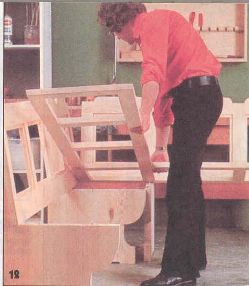
12 Задние кромки сидений рам подгоняют (скашивают) к наклонным спинкам. После этого рамы крепят на шкантах с клеем и шурупах. Шканты должны плотно входить в отверстия в рамах и ножках.
